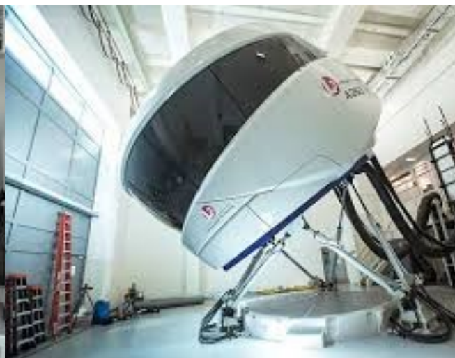
Rys. 5zag_03. Przykłady rozwiązań konstrukcyjnych zintegrowanych symulatorów wykonanych w oparciu o pojedynczą Platformę Stewarta
