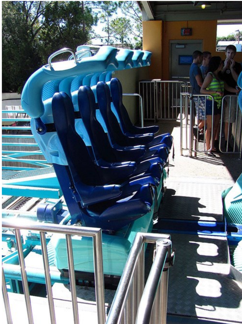
Rys. 7zag_10. Zabezpieczenia typu OTSR, Kraken, SeaWorld Orlando, USA.
