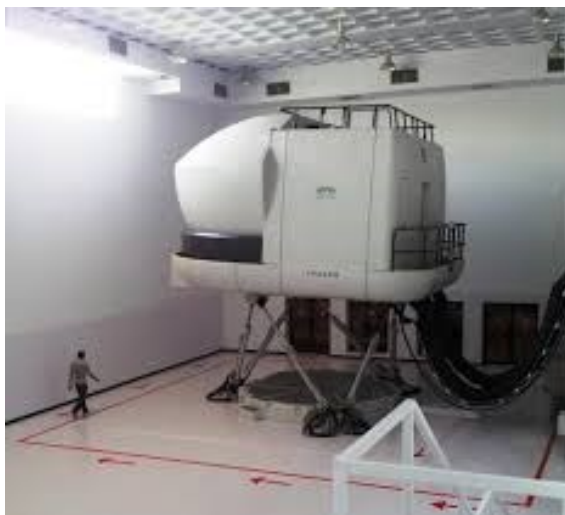
Rys. 5zag_03. Przykłady rozwiązań konstrukcyjnych zintegrowanych symulatorów wykonanych w oparciu o pojedynczą Platformę Stewarta
