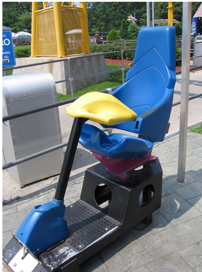
Rys. 6zag_10. Zabezpieczenia typu T-bar, fotel testowy kolejki Nitro, Six Flags Great Adventure, USA.
