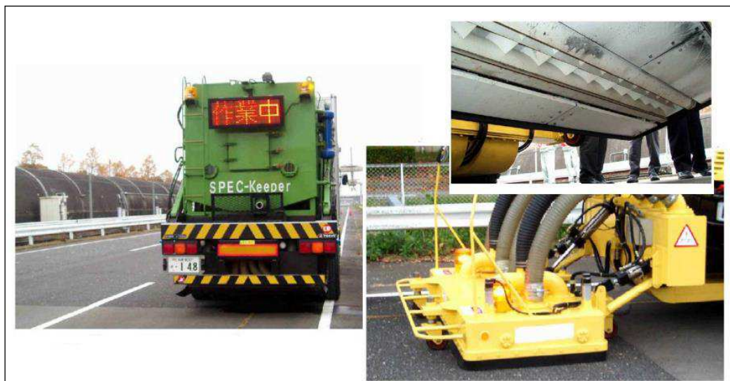
Rysunek 3. Sprzęt wykorzystywany przy oczyszczaniu nawierzchni z asfaltu porowatego [Źródło: Zastosowanie nowoczesnych technologii w konstrukcjach drogowych, Zakopane 15-17.09.2010 r.]
