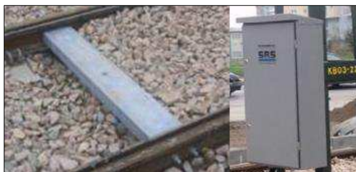
Rysunek 9. Przykład smarownicy torowej SRS oraz szafy z aparaturą sterowniczą smarownicy [Źródło: www.transportszynowy.pl]
