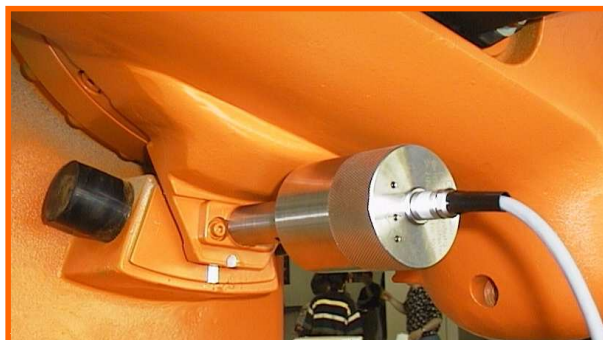
Elektroniczny czujnik pomiarowy (EMT)
