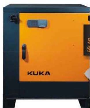
Układ sterowania robota
