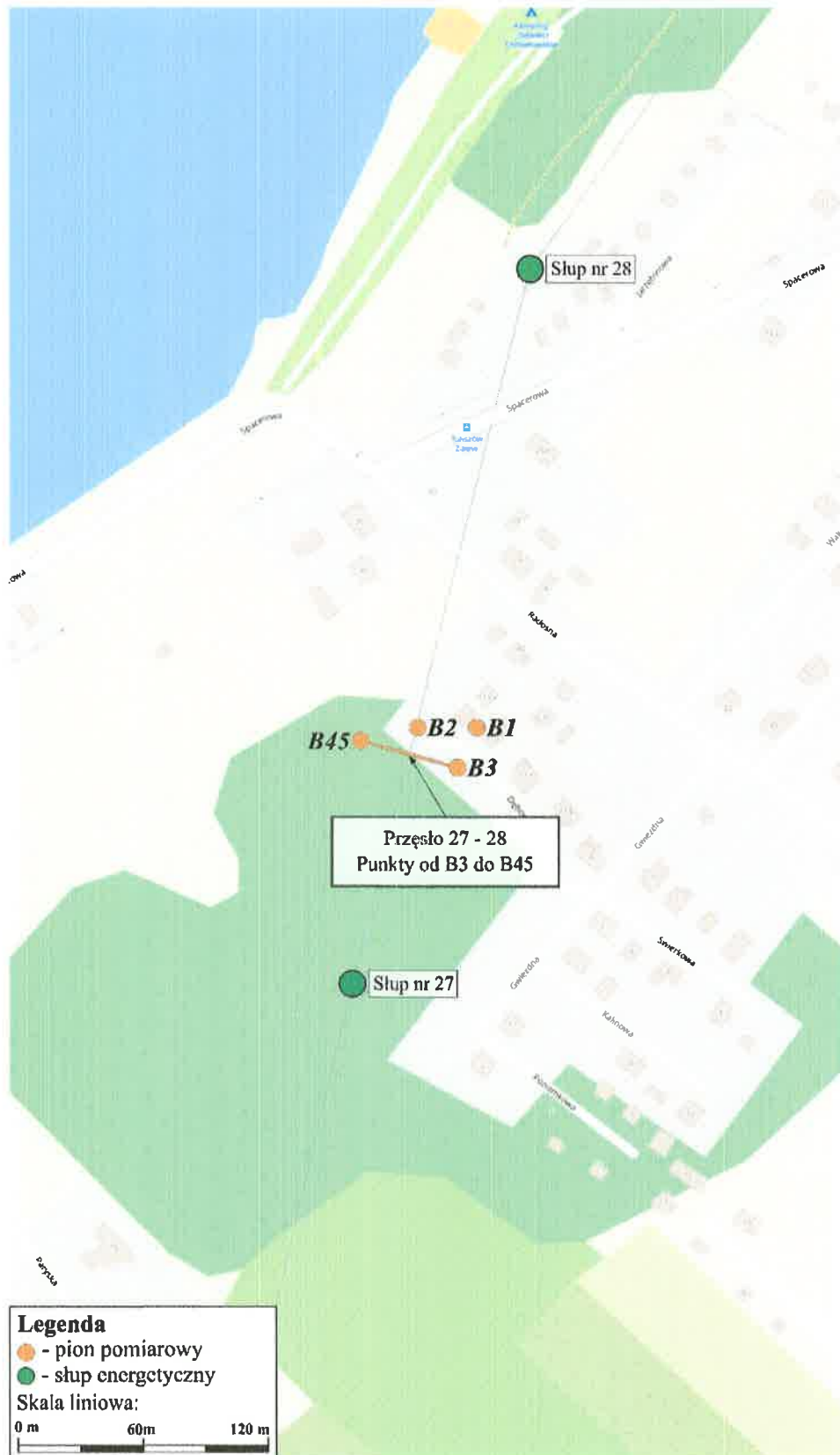
Rys. 2. Lokalizacja pionów pomiarowych, przęsło 27 – 28.
