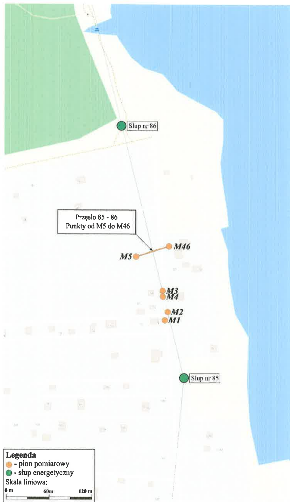
Rys. 13. Lokalizacja pionów pomiarowych, przęsło 85 – 86.
