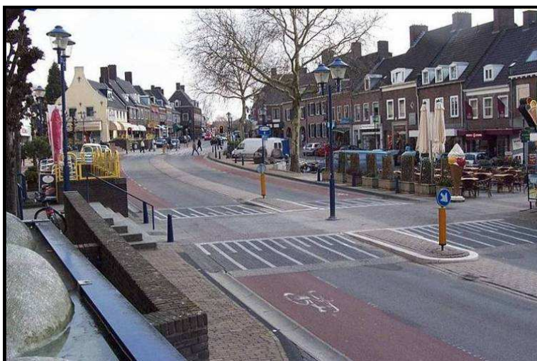
Fot. 6. Przykład strefy ruchu uspokojonego o dopuszczalnej prędkości 30 km/h w centrum miejscowości (Holandia)
