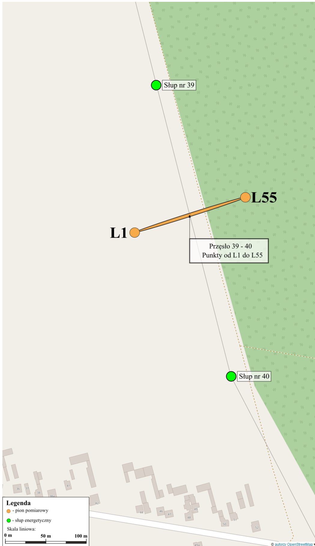
Rys. 12. Lokalizacja pionów pomiarowych dla przęsła nr 39-40.
