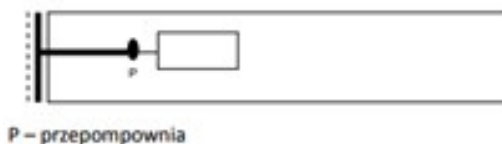
Rysunek 2. Kanalizacja ciśnieniowa
