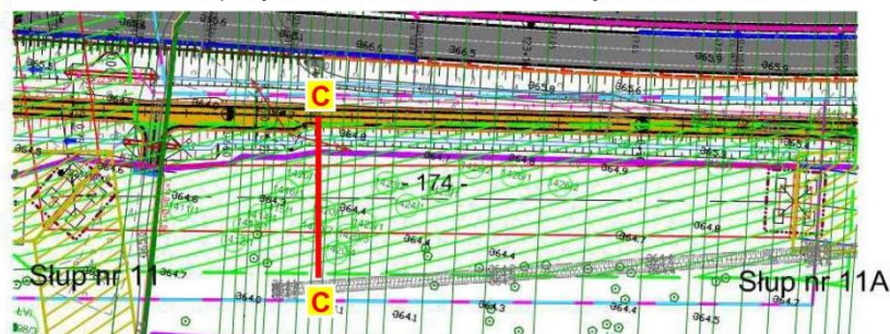
Rysunek 3. Przekrój pomiarowy natężenia pola-E i pola-M w przęśle 11-11A linii 220 kV relacji Łośnice - Siersza
