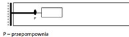
Rysunek 2. Kanalizacja ciśnieniowa
