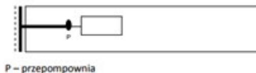
Rysunek 2. Kanalizacja ciśnieniowa
